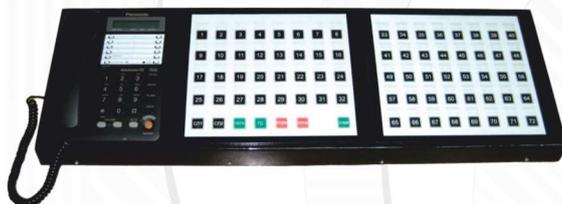
**Шкаф связи.** В зависимости от емкости комплекса, поставляется один шкаф (до 160 абонентов) или несколько. Максимальная емкость комплекса ШТСИ4 – 280 абонентов, причем все они, или их часть, могут быть прямыми абонентами диспетчера.
