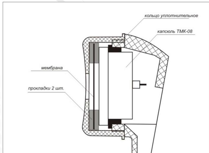
Размеры уплотнительных деталей подходят для установки в трубки телефонных аппаратов вышеперечисленных моделей. Уплотнительные кольца, мембраны и прокладки могут быть включены в комплект поставки в любой комбинации.
