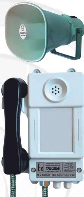
Телефонные аппараты с громкоговорящей связью ТАШ-22ExB, ТАШ-22ExC взрывозащищенные без номеронабирателя предназначены для обеспечения устойчивой телефонной и громкоговорящей связью, а также аварийной сигнализацией производственных зон и открытых площадок, имеющих опасность возникновения взрывоопасных сред.
